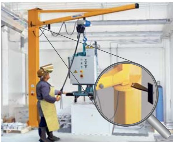
Schwenkansschläge verstellbar (Bild 5)
