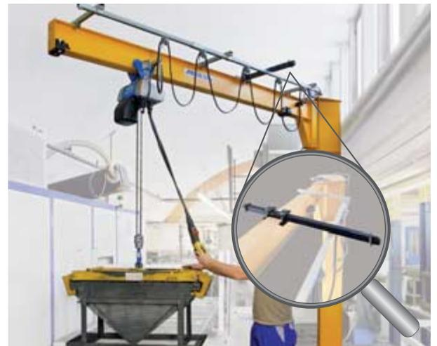
Schwenkansschlag Pufferstange (Bild 4)
