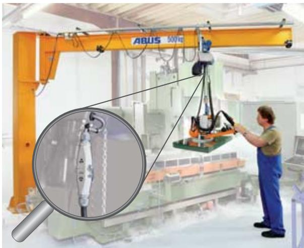
Schwenkran mit Vakuumgerät u. Stecker (Bild 13)
