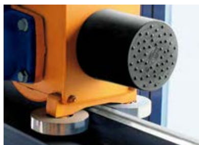
Vodící kladky na horním nosníku pojezdového ústrojí
