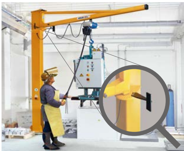
Nastavitelné dorazy otáčení (obrázek 5)
