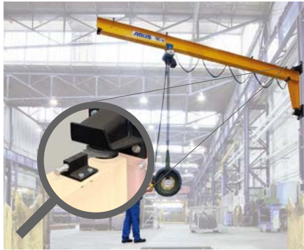
Regulace odporu otáčení (obrázek 10)
