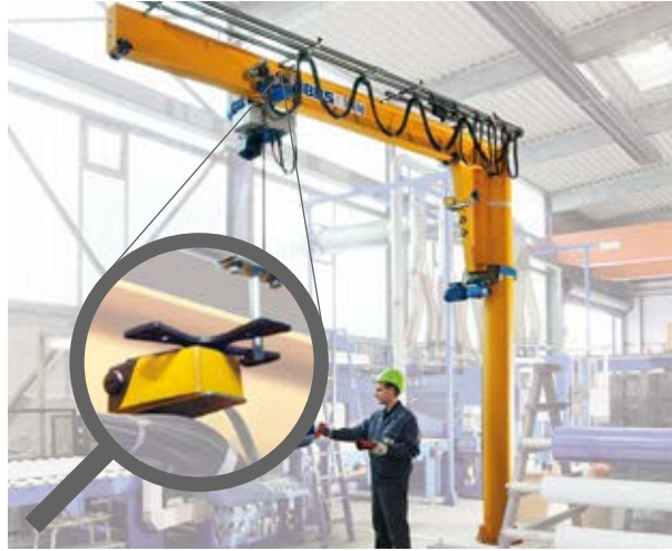
Mezní spínač pojezdu kočky (obrázek 8)
