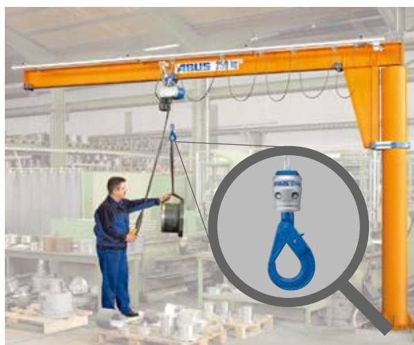
Bezpečnostní nosný hák (obrázek 14)
