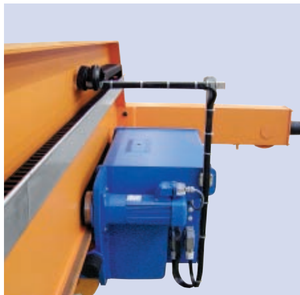
Přenos signálu a přívod el. proudu ke zdvihacímu ústrojí
