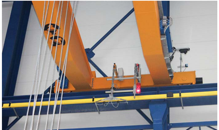
Jeřábová dráha s detailem napájení a pojezdu ITECO-ABUS ZLK 25/15 D
