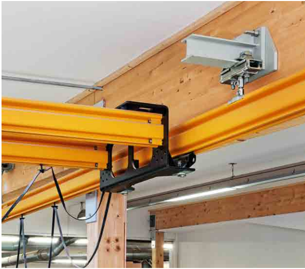
Zadní ukotvení normální konzoly na dřevěném lepeném vazníku.
